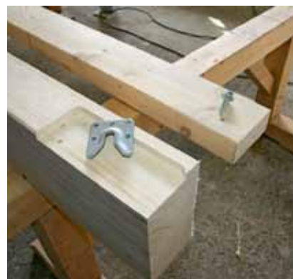
Die Abbundanlage fräst Nuten sowie Ausnehmungen und bohrt Löcher für die schnelle und einfache Montage des Verbinders
