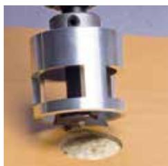
1) Einfaches Bohren mit Tiefenanschlag
