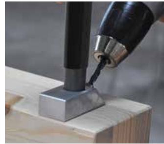
❸ Schrägverschraubung mit Knapp-Bohrschablone vorbohren.
