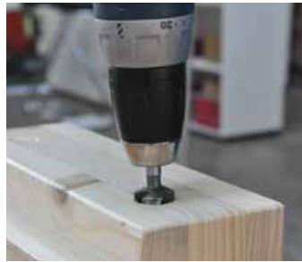
❷ T-JOINT 20 Bohrung mit ca. 2mm Fase ansenken.
