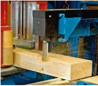
❶ Ausfräsung und Vorbohrungen mit der Abbundanlage herstellen.
