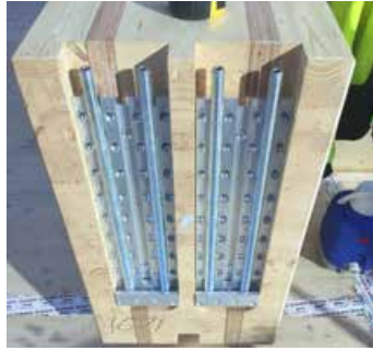
Montage encastré sur 3 côtés avec usinage en bout de panne et fixation de la plaque principale en applique sur le porteur.
