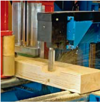
1a) Usinage sur centre de taille numérique
