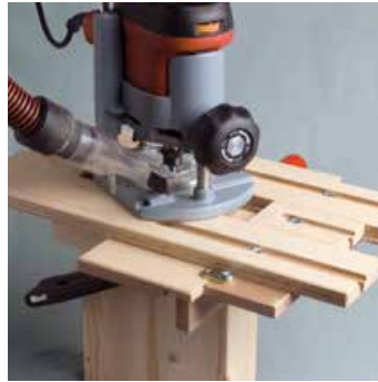
1b) Usinage manuel avec gabarit et défonceuse portable.
