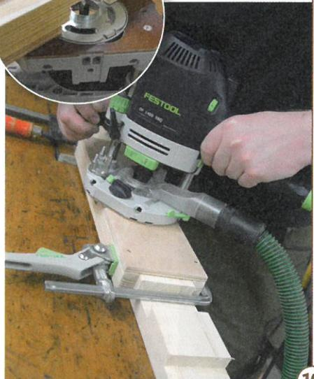
19 > Die Oberfräse räumt die Taschen für die Stäbe (Latten) in den Tragleisten aus. Die Tragleisten können paarweise (oder wie im Bild zu sehen, alle vier – bei zwei Betten) auf einmal bearbeitet werden. Die Schablone für die Kopierhülse führt nicht nur die Oberfräse, sie verhindert auch Ausrisse an den Außenseiten der Tragleisten.
