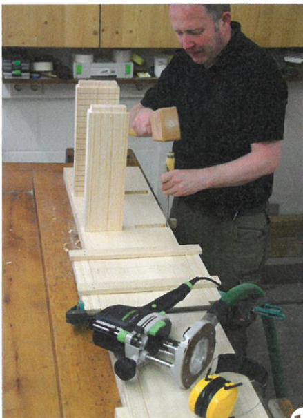
**12** > Die Stufen werden in 15 mm tiefen Taschen der Seiten gehalten. Die Oberfräse wird in einem Holzrahmen dazu geführt. An den Ecken arbeitet das Stecheisen nach.
