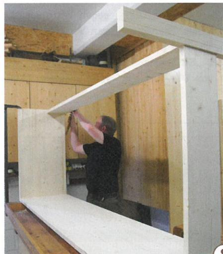
**8** > Das später an der Wand befestigte Hochbett wird auf der Hobelbank liegend zusammengebaut. Auch hier zeigt sich, ob alle Teile zusammenpassen. Bei dieser Bettvariante wird ebenfalls eine Verbreiterung an das frei stehende Teil der Leiter angeleimt. Dort wird später die Absturzicherung (zwei 35-mm-Rundstäbe) 15 mm tief eingebohrt.
