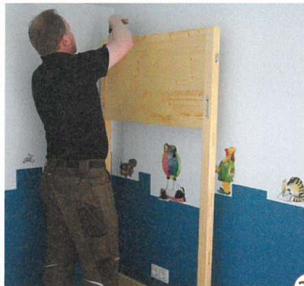
22 > Nun zur Montage des Pfostenbetts: Ganz einfach lassen sich die Einzelteile von Kopf- und Fußrahmen zusammenstecken. Begonnen wird mit zwei Pfosten und der unteren Strebe, dann wird das breite Kopf beziehungsweise Fußteil eingesteckt.
