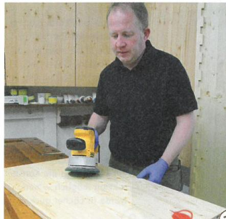
21 > Die Oberflächen der Betten werden hier mit einem Öl von Asuso (Nature Line) behandelt. Es trocknet etwas langsamer und wird nur einmalig aufgetragen. Vorgehensweise: Öl auftragen, mit grünen Schleifpad einarbeiten, nach 30 Minuten die Überschüsse mit einem weichen Tuch entfernen.
