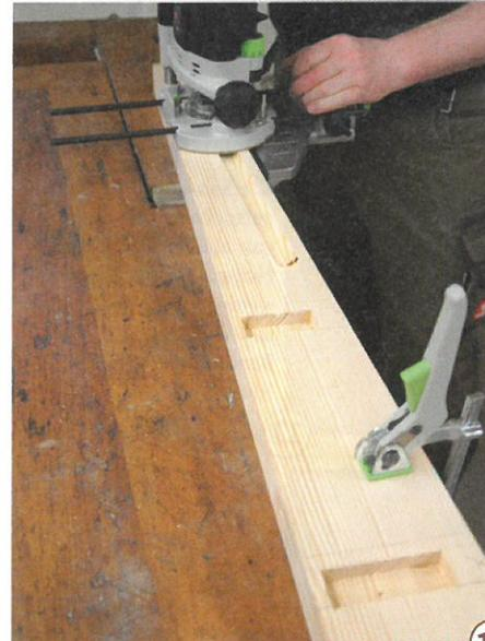
**13** > Die angeschrägten Seiten erhalten oberhalb der Stufen beidseitig eine Griffnut. Auf der Außenseite kann diese Griffnut weiter nach unten gefräst werden. Ein 25-mm-Hohlkehlfräser kommt hier 35 mm von der Kante zum Einsatz. Später wird die Kante mit einem Abrundfräser mit Kugellager ( $r = 9,5 \text{ mm}$ ) rund gefräst. So entsteht ein Omega-förmiges Handlaufprofil ähnlich wie beim Treppenbau.
