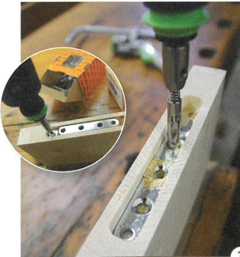
**3** > Ein Zentrierbohrer hilft beim Bohren der Verbinder. Sie werden mit Schrauben 5 x 60 befestigt. Zum Einsatz kommt je eine Rundkopfschraube, in die sich das Gegenstück des Verbinders einhängt und je nach Verbinder eine oder mehrere Senkkopfschrauben. Zum Einstellen des Anpressdrucks wird die Rundkopfschraube etwas ein- oder ausgedreht.
