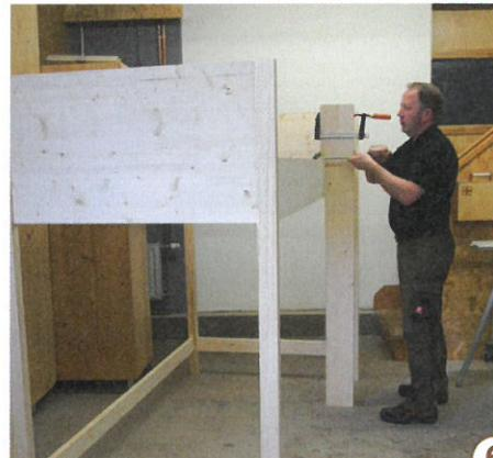
**6** > Beim ersten Zusammenbau in der Werkstatt sieht man, ob alle Teile zusammen passen. Im gleichen Zug wird die Verbreiterung an der freien Treppenseite oberhalb der Bettseite angeleimt. Hier wird später die Absturzicherung aus zwei 35-mm-Rundstäben 15 mm tief eingebohrt.
