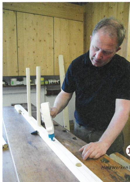
**16** > Verleimen Sie die Sprossen des wandhängenden Bettes mit den Leiterseiten. Achten Sie unbedingt darauf, dass alle Einschnitte für die Keile quer zum senkrechten Faserverlauf der Leiterseite stehen. Sonst könnten die folgenden Keile hier spaltend wirken.
