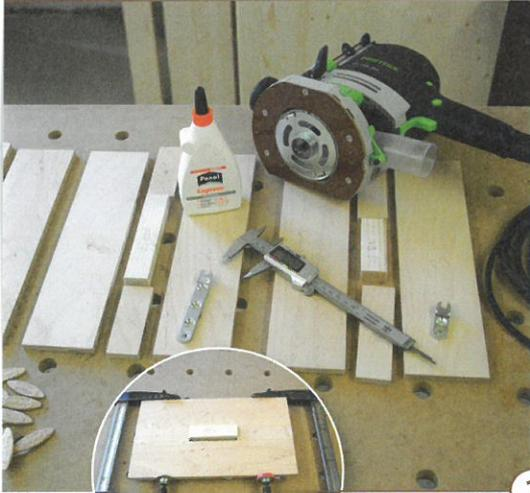
**1** > Zum Gestellbau allgemein: Für das Fräsen der Duo-Verbinder sind Schablonen wichtig. Diese werden aus 15-mm-Multiplexplatte verleimt. Sie führen die mit einem Kopiering ausgerüstete Oberfräse. Da Verbinder mit unterschiedlichen Längen zum Einsatz kommen, werden mehrere Schablonen benötigt.
