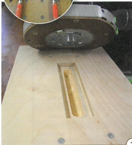
**2** > Mit einem 15-mm-Fräser fräst man die Taschen im Hirnholz 13 mm tief. Achten Sie unbedingt auf eine 10-mm-Verschiebung der Frästaschen gegeneinander an den Knotenpunkten, damit später am Pfosten die Befestigungsschrauben nicht aufeinander treffen.
