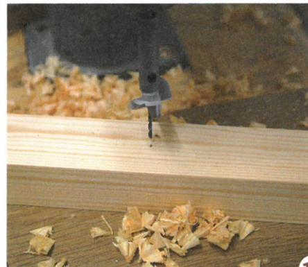
**14** > Die Leiter des Wandbetts wird anders konstruiert: Zum Bohren der Seiten kommt ein 35-mm-Forstnerbohrer mit Wechselspitze zum Einsatz. Nur der kleine Bohrer bohrt beim ersten Durchgang ganz durch. Dann das Werkstück wenden und den kleinen Bohrer in diesem Löchlein ansetzen. So entstehen außen keine Ausrisse.
