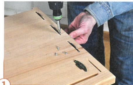
**1** Stecken Sie die Verbinderhälften in die Flachdübelschlitz und richten Sie sie mittig im Schlitz aus. Danach drehen Sie an den Enden dicht am Verbinder anliegend zwei „Pan-head“-Schrauben (werden mitgeliefert) ein.
