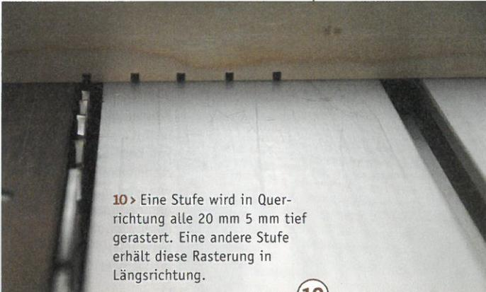
**10** > Eine Stufe wird in Querrichtung alle 20 mm 5 mm tief gerastert. Eine andere Stufe erhält diese Rasterung in Längsrichtung.
