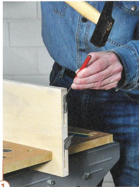
Neben dem Verbinder „Silver“ besitzen auch die Verbinder „Sunny“ und „Fast“ auf beiden Seiten vorstehende Schneidkanten. Alle diese Verbinder werden daher an das Ende der Flachdübelnut angesetzt und am Nutgrund anliegend mit dem Hammer etwas eingeschlagen, bis die Schneidkanten im Holz greifen. Das komplette Versenken bzw. Einschlagen des Verbinders erledigen Sie zum Schluss mit einem 4-mm-Splinttreiber.
