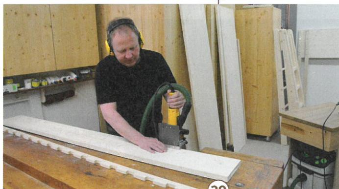
20 > Bevor die Tragleisten an die Seiten angeleimt werden, fräsen Sie mit der Flachdübelfräse unterhalb der Ausfräsung für die Latten auf jeder dritten Tasche einen Flachdübel ein. So verbindet sich später die Tragleiste kraft- und formschlüssig mit der Bettseite.
