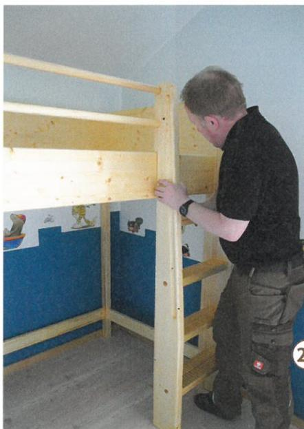
24 > Zusammen mit den Rundstäben der Absturz-sicherung wird die Leiter von oben eingehängt. Sie wird von DUO 46/15-Verbindern an Pfosten und Bettseite gehalten.
