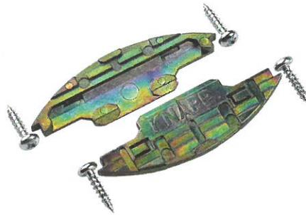
Für Harthölzer und Multiplexplatten eignet sich am besten der Verbinder Typ „Metall“. Er wird nur von oben in den Flachdübelschlitz gesteckt und an den Enden mit je einer Schraube gesichert.
