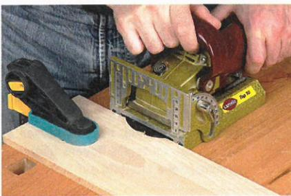
1. Spannen Sie ein 10 mm dickes Brett (Massiv- oder Sperrholz) auf der Werkbank fest und fräsen Sie mit beiden (!) Händen einen Schlitz in die Kante. Halten Sie das Brett auf gar keinen Fall mit den Händen fest!
