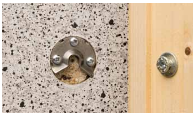
Im Türen- und Fensterbau kommt unter anderem der Einhängerverbinder Uno 30 zum Einsatz, der Scherkräfte bis 150 kg aufnehmen kann.
