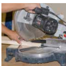
1) Couper FIXclip-Barre et les parcloles à dimensions
