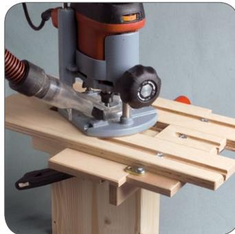
1) Usinage avec défonceuse et gabarit – encastrement de 60 ou 80 mm de larg. et 25 mm de prof. (long. suivant notice). Longueur d'usinage indiquée sur les notices de montage respectives.
