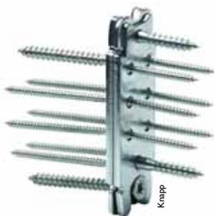
Le fabricant autrichien de connecteurs propose Ricon, un système d'assemblage poteau-traverse et poutre, qui se compose de deux ferrures identiques en acier galvanisé à chaud. Une fois monté, aucune partie de l'assembleur ne reste visible. L'encoche de forme conique permet une prise optimale aux vis
