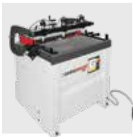
Bohren mit Dübelautomat
