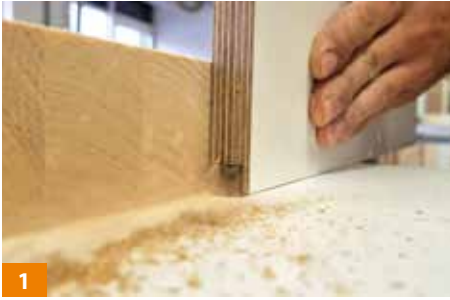
1 Platten auf die gewünschte Tiefe fräsen.
