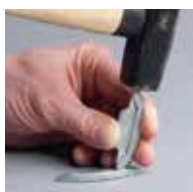
Sperrlaschen gegen- gleich ausbiegen (optional)
