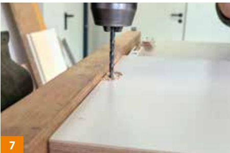
7 Löcher für Schulterkopfschrauben bohren.
