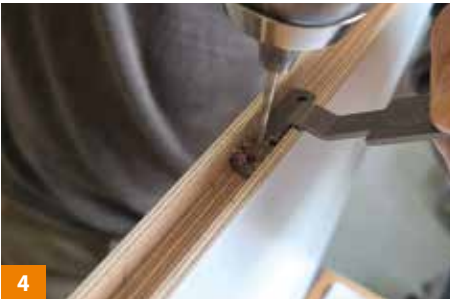
4 Bohrungen anhand der Bohrschablone ausführen.
