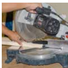
Glasleiste und FIXclip-Schiene zuschneiden
