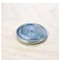
Bohrposition mit Körner übertragen
