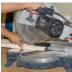
Glasleiste und FIXclip-Schiene zuschneiden
