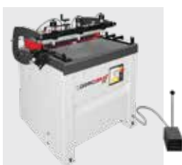
Bohren mit Dübelautomat
