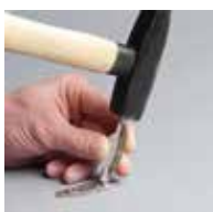
Sperrlaschen gegen- gleich ausbiegen
