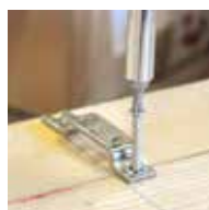
KOMBI Haltebügel am Werkstück festschrauben
