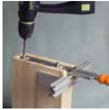
Fräsen mit Ø30 Kopierhülse und Frässhablone
