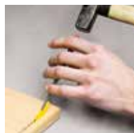
Mit Einschlagwerk- zeug in Position bringen
