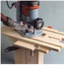
Fräsen mit Ø30 Kopierhülse und Frässhablone
