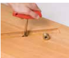
Einschraubmutter anschrauben (SW 10)
