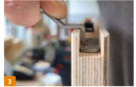
3 Bohrschablone in Position bringen.
