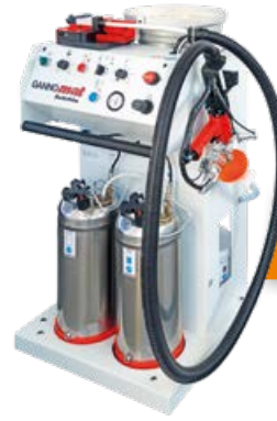
Poseuse-encolleuse de tourillons GANNOMAT Selektä
