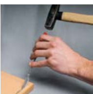
Finir le positionnement avec le chasse clou
