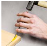
Finir le positionnement avec le chasse clou
