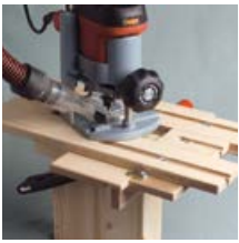
Fräsen mit Ø30 Kopierhülse - Vorbohren se und Frässchablone
