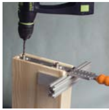
Fräsen mit Ø30 Kopierhülse - Vorbohren se und Frässchablone
