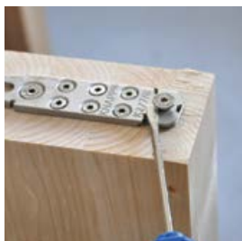
Montage de la goupille de verrouillage
