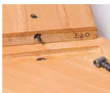
Spannelement in Bohrungen einlegen
