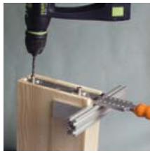
Fräsen mit Ø30 Kopierhülse und Frässhablone
