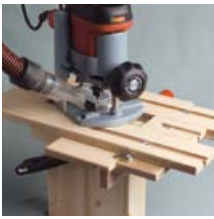
Fräsen mit Ø30 Kopierhülse und Frässhablone
