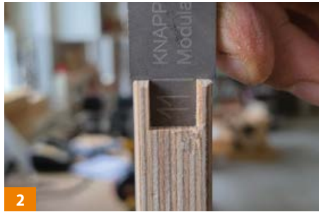
2 Kontrolle mit der Prüfschablone.
