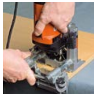
oder Bohren mit DUO- Dübler
