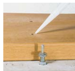
Kleber auftragen und zusammenbauen
