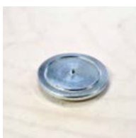
Bohrposition mit Körner übertragen
