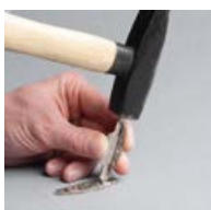
Sperrlaschen gegen- gleich ausbiegen
