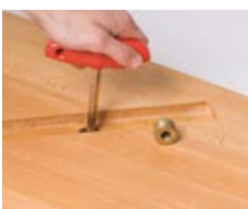
Einschraubmutter anschrauben (SW 10)
