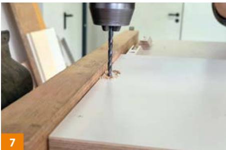
7 Löcher für Schulterkopfschrauben bohren.
