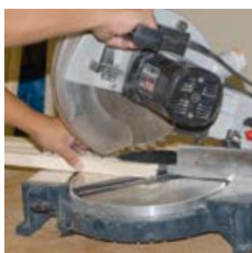
Glasleiste und FIXclip-Schiene zuschneiden
