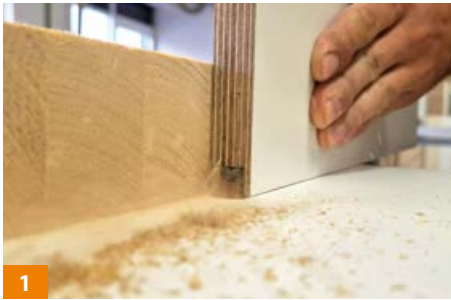
1 Platten auf die gewünschte Tiefe fräsen.
