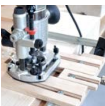
Fräsen mit Frässhablone
