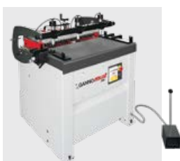
Bohren mit Dübelautomat
