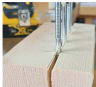
Comportement de fendage avec des vis traditionnelles pour la construction en bois.
