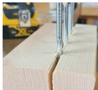
Spaltverhalten mit herkömmlichen Holzbauschrauben.
