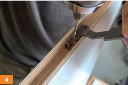
4 Bohrungen anhand der Bohrschablone ausführen.
