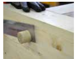
Überstand abschneiden und verschleifen.
