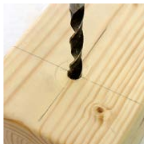
Falls erforderlich Ausfräsung herstellen, Bohrungen anzeichnen.
