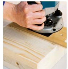
Abbundmaschine oder Ausfräsen mit Oberfräse
