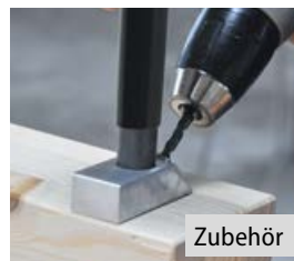
Mit T-JOINT-Bohrschablone vorbohren.
