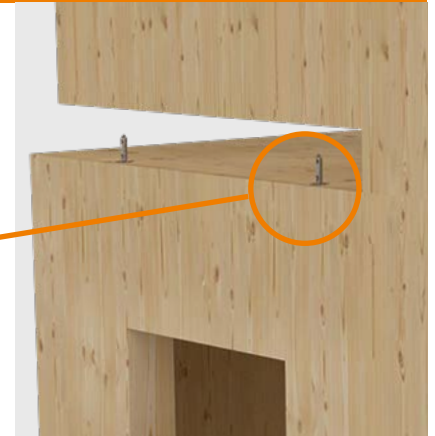
Detail: WALCO® BOLT B130 Wand-Wand Verbindung
