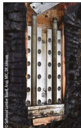
RICON®S Verbinder nach 120 minütigem und MEGANT® Verbinder nach 60 minütigem Brandversuch. Das Holz ist rings herum verkohlt. Die Verbinder hielten in dem Brandversuch der aufgetragenen Vertikallast stand.
