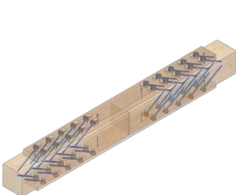
T-JOINT D35 W30 befestigte Laubholzlaschen von BSH-Zugstößen
