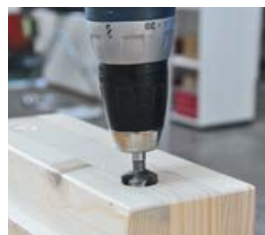
T-JOINT D20 Bohrung ca. 3 mm ansenken.
