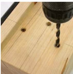
Vorbohren der Positionierschraubung.
