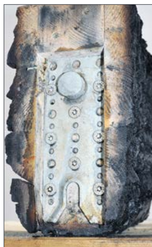
RICON®S Verbinder nach 120 minütigem und MEGANT® Verbinder nach 60 minütigem Brandversuch. Das Holz ist rings herum verkohlt. Die Verbinder hielten in dem Brandversuch der aufgetragenen Vertikallast stand.
