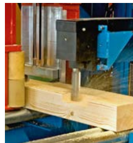
Abbundmaschine oder Ausfräsen mit Oberfräse
