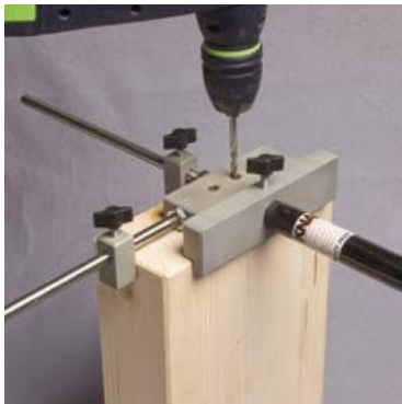
Vorbohren des Nebenträger
