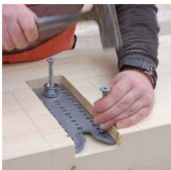
Positionnement des ferrures et vis
