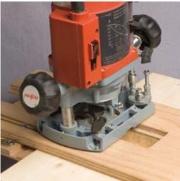
Usinage manuel avec gabarit et défonceuse portative
