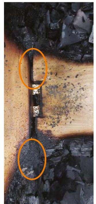
La jonction de 10 mm est fermée par le joint intumescent qui gonfle, ce qui permet au connecteur d'être bien protégé même après 120 min de feu.
