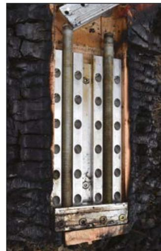
RICON®S après un essai de tenue au feu 120 minutes et MEGANT® après un essai de 60 minutes. La section de bois est carbonisée tout autour du connecteur. Elle a garanti son intégrité et ses capacités de résistance à l'effort vertical exercé.
