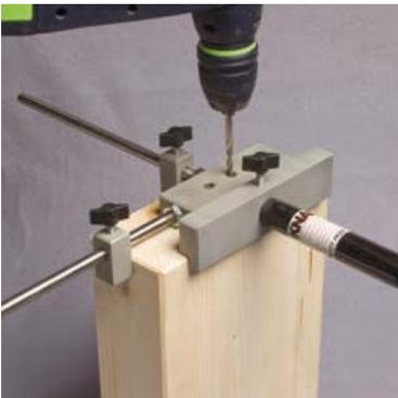
Pré-perçage poutre secondaire
