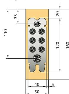
Profondeur d'encastrement : 12 - 12,5 mm
