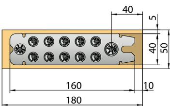
Profondeur d'encastrement : 12 - 12,5 mm
