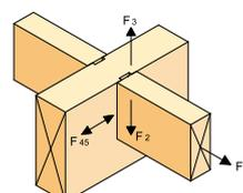
\* alternative possible avec vis plus longues en bois de bout sur PS : 2 vis TF 8x160 - F<sub>2,Rk</sub> = 10,3 kN
