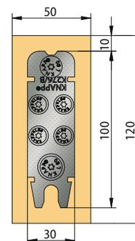
Profondeur d'encastrement : 11 - 11,5 mm    Épaisseur minimum : 50 mm
