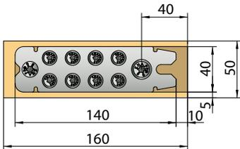
Profondeur d'encastrement : 12 - 12,5 mm
