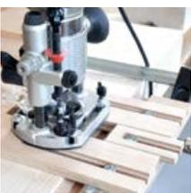
Usage manuel avec gabarit et défonceuse portable ou centre d'usinage
