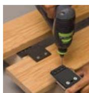
Positionner et pré-percer avec le gabarit
