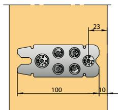
Encastrement et vissage sur poutre principale
