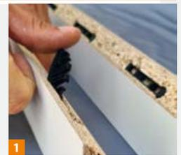
Insérer les pièces l'une en face de l'autre dans les rainures à épaulement.
