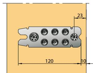
Encastrement et vissage sur poutre principale
