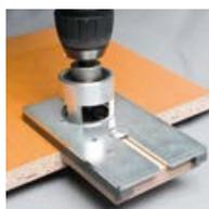
Percer avec le gabarit ou suivant dimensions
