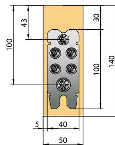
Profondeur d'encastrement : 12 - 12,5 mm
