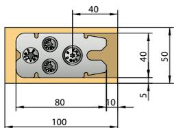
Profondeur d'encastrement : 12 - 12,5 mm
