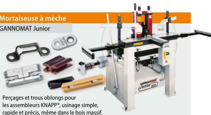
Perçages et trous oblongs pour les assembleurs KNAPP®, usinage simple, rapide et précis, même dans le bois massif.
