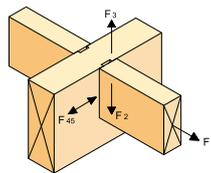
\* alternative possible avec vis plus longue en bois de bout sur PS : 1 vis TF 8x160 - F<sub>2,Rk</sub> = 6,3 kN
