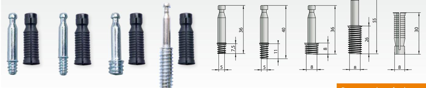
Remarque : la profondeur de perçage 31-32 mm des chevilles plastiques doit être respectée pour un bon fonctionnement du système.
