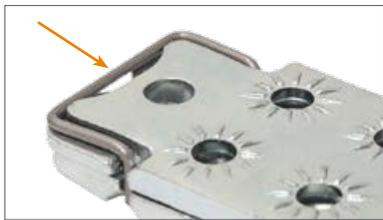
Pour démonter la goupille, il suffit de frapper sur son milieu avec un tournevis plat. La goupille se plie, sort des ergots et laisse l'assemblage libre.
