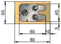
Profondeur d'encastrement : 12 - 12,5 mm
