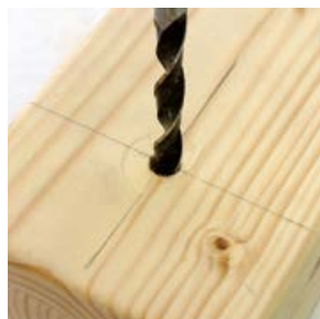
Falls erforderlich Ausfräsung herstellen, Bohrungen anzeichnen.
