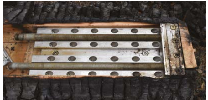
MEGANT® Verbinder nach 60 minütigem Brandversuch. Das Holz ist ringsherum verkohlt. Der Verbinder hielt in dem Brandversuch der aufgetragenen Vertikallast stand.
