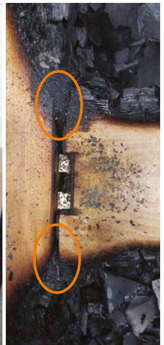
Die 10mm Fuge wird durch das aufquellende Brandschutzlaminat geschlossen, wodurch der Verbinder auch nach 120min Branddauer gut geschützt ist.
