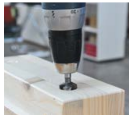
T-JOINT D20 Bohrung ca. 3 mm ansenken.
