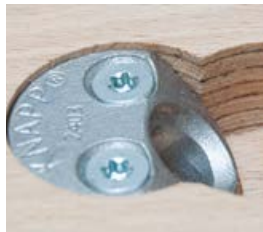
T-JOINT D30 oder D35 mit 2 Stk. SK Ø 5mm vormontieren¹.
