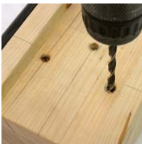
Vorbohren der Positionierschraubung.
