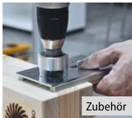
Handwerkliche Verarbeitung mit Knapp Bohrschablonen.
