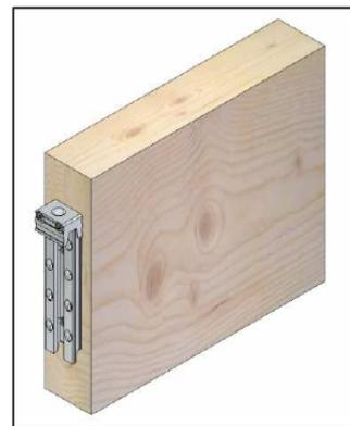
NT3: fertig gestellt mit oberer Spannbacke
