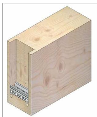
NT1: untere Spannbacke in Vorfräsung
