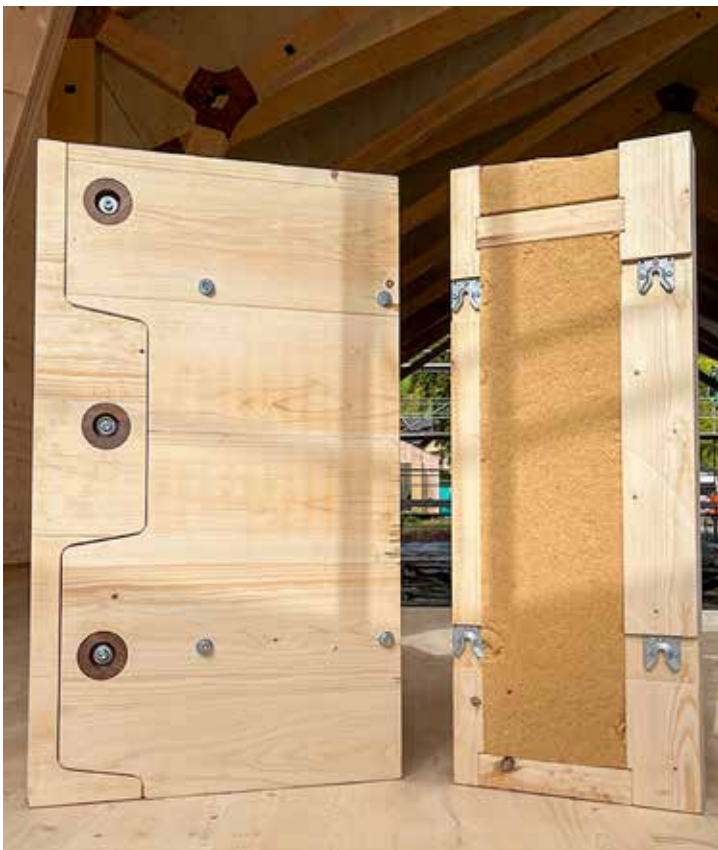
Das Fassadenmodell zeigt kreislauffähige Befestigungsmittel für nachhaltigen Holzbau: links die Konusadapter, rechts Knapp-Verbinder.
