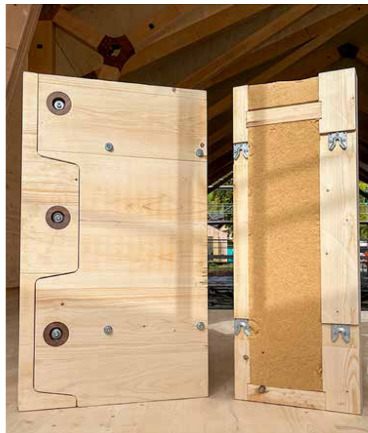
Das Fassadenmodell zeigt kreislauffähige Befestigungsmitel für nachhaltigen Holzbau: links die Konusadapter, rechts Knapp Verbinder.
