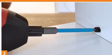
**2** Le verrouillage par vis pointeau permet de sécuriser l'assemblage tout en laissant la possibilité de démontage et remontage.
