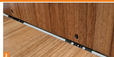
**3** Assemblage en coupe d'onglet 45° (aide au collage)
