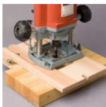
Fräsen mit Frässhablone
