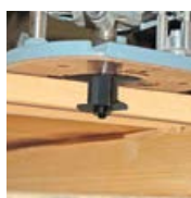
Fräsen mit Oberfräse (optional)
