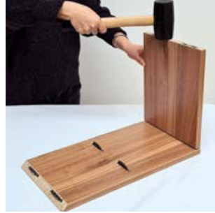
Mit einem Gummihammer den Selbstspann-Mechanismus auslösen.
