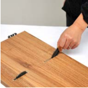
Verbinder flächenbündig einstecken.
