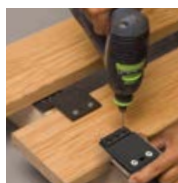
Vorbohren mit Schablone
