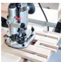
Fräsen mit Frässchablone
