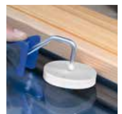
Leichte Verarbeitung mit Dichtungsroller
