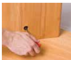
Elemente verspannen (SW 4)
