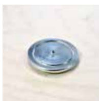
Bohrposition mit Körner übertragen
