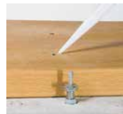
Kleber auftragen und zusammenbauen
