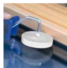
Leichte Verarbeitung mit Dichtungsroller
