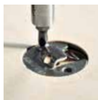
Den Verbinder positionieren mittels der Haltespitzen
