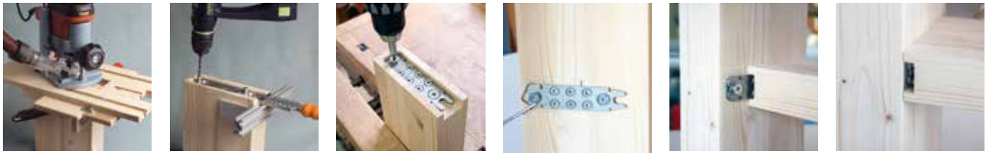
Fräsen mit Ø30 Kopierhülse und Frässhablone
