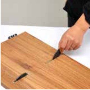
Verbinder flächenbündig einstecken.
