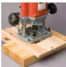
Fräsen mit Frässhablone
