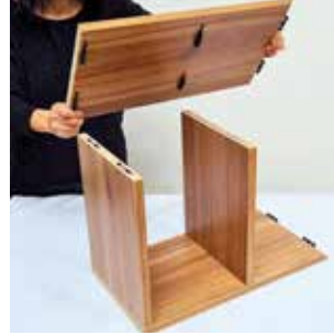
Mit einem Gummihammer den Selbstspann-Mechanismus auslösen.
