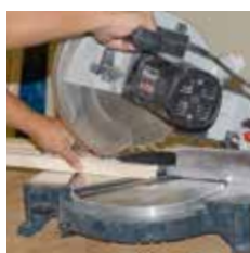
Glasleiste und FIXclip-Schiene zuschneiden
