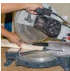
Glasleiste und FIXclip-Schiene zuschneiden
