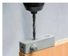
In Nut vorbohren
