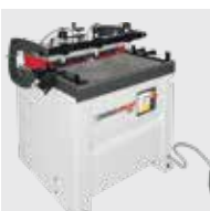
Bohren mit Dübelautomat
