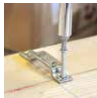
Visser les supports KOMBI sur la pièce porteuse
