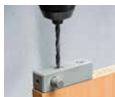
Pré-percer dans la rainure
