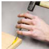
Finir le positionnement avec le chasse clou
