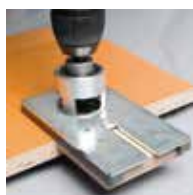
Percer avec le gabarit ou suivant dimensions
