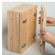
Fixer les lamelles à crochet sur le panneau
