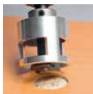
Percer avec le gabarit ou suivant dimensions
