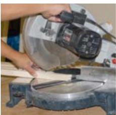
Glasleiste und FIXclip-Schiene zuschneiden
