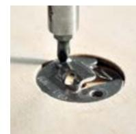
Den Verbinder positionieren mittels der Haltespitzen
