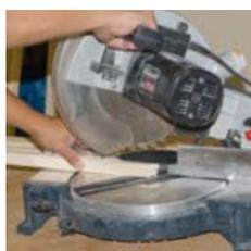
Glasleiste und FIXclip-Schiene zuschneiden
