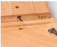
Spannelement in Bohrungen einlegen
