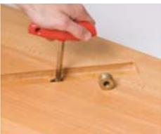
Einschraubmutter anschrauben (SW 10)
