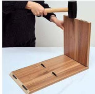
Mit einem Gummihammer den Selbstspann-Mechanismus auslösen.
