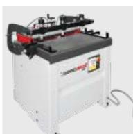
Bohren mit Dübelautomat
