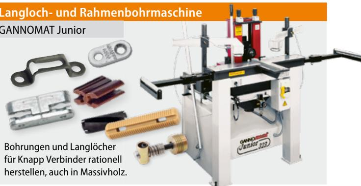
Bohrungen und Langlöcher für Knapp Verbinder rationell herstellen, auch in Massivholz.
