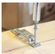
KOMBI Haltebügel am Werkstück festschrauben
