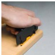
Einsetzen und mit Schablone positionieren
