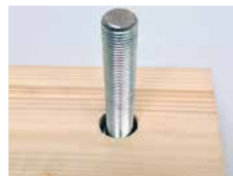
Vissage de la tige filetée dans l'insert.
