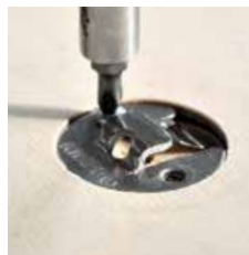
Den Verbinder positionieren mittels der Haltespitzen
