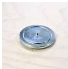
Bohrposition mit Körner übertragen
