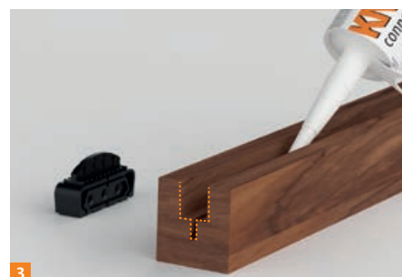
3 Fraiser les rainures à double niveau puis les encoller aux positions des clips avec la colle KNAPP® PU+. Engager les profilés bois décoratifs sur les clips et laisser la colle durcir.
