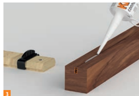
3 Fraiser des rainures de 4x12 mm puis les encoller aux positions des clips avec la colle KNAPP® PU+. Engager les profilés bois décoratifs sur les clips et laisser la colle durcir.
