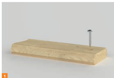
1 Positionner et fixer le profil d'accroche.
