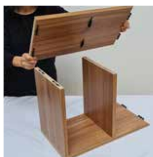
Réaliser le montage par emboîtement des éléments en exerçant une pression manuelle ou au maillet.
