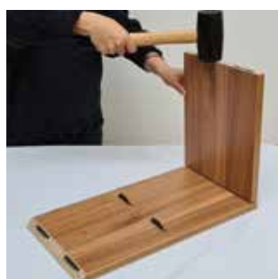
Réaliser le montage par emboîtement des éléments en exerçant une pression manuelle ou au maillet.
