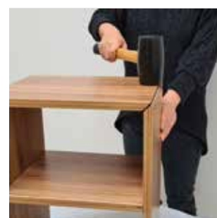
Réaliser le montage par emboîtement des éléments en exerçant une pression manuelle ou au maillet.
