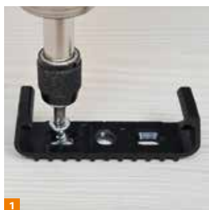
1 Mit Ø 4 mm SK-Schrauben befestigen.
