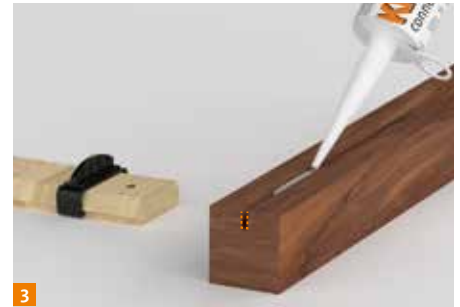
3 Nuten 4x12 mm fräsen und KNAPP®-Kleber PU+ in die Nut füllen oder auf den Lamellensteg auftragen. Leisten auf die Klammer aufstecken.
