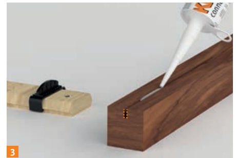
3 Fraiser des rainures de 4x12 mm puis les encoller aux positions des clips avec la colle KNAPP® PU+. Engager les profilés bois décoratifs sur les clips et laisser la colle durcir.
