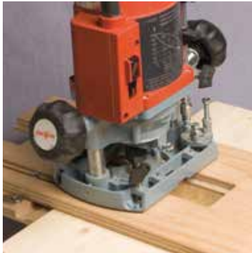
Usinage manuel avec gabarit et défonceuse portative
