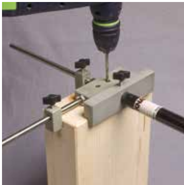
Pré-perçage poutre secondaire
