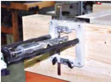
Perçage manuel à l'aide d'une mèche étagée ou sur machine de taille numérique.
