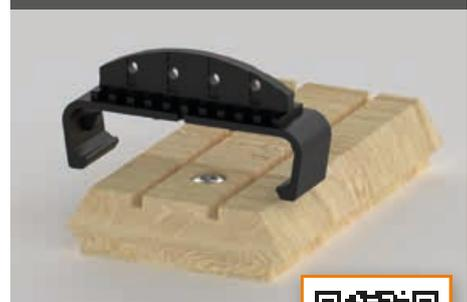
Optional kann anstelle des DEKLICK Blocks eine aus Holz gefräste Blockleiste eingesetzt werden (ein passender Fräser ist erhältlich). Diese wird auf die Trägerkonstruktion aufgeschraubt und in Position gebracht. Die Klammern können einfach und flexibel in Längsrichtung der Blockleisten verschoben und perfekt justiert werden. Für größere Flächen eignet sich die Montage mit Blockleisten optimal.
