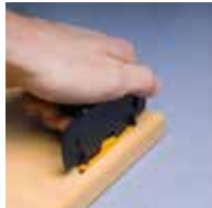
Positionner et régler avec le gabarit
