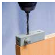
Pré-percer dans la rainure
