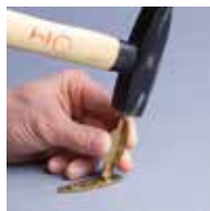
Percuter la languette/ butée si nécessaire
