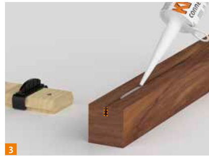
3 Wyfrezować rowki 4x12 mm i wypełnić je klejem KNAPP® PU+ w rowku lub na mostku klamry. Zamontować listwy na mostku klamry.
