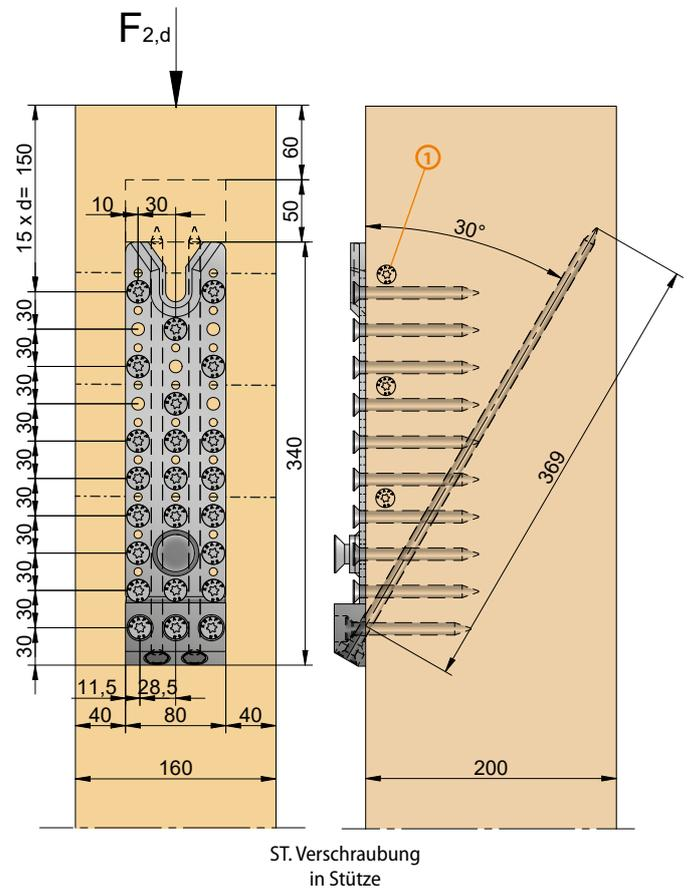
① Anordnung von Vollgewindeschrauben zur Querkzugverstärkung. Laut Gutachten (10.09.2021) von Prof. Dr. Blaß, sollen die Querkzugschrauben den gleich Schrauben Durchmesser wie die verwendeten RICON®S Schrauben besitzen. Diese Schrauben sollen eine Länge wie die Stützenquerschnittsbreite aufweisen.
