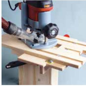
Mit der Frässhablone und Oberfräse wird am Riegel eine 60 mm bzw. 80 mm breite und 25 mm tiefe Ausfräsung hergestellt (Länge laut Montageanleitung).
