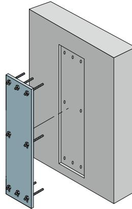
**I** Betonanschluss mit eingeklebten Gewindestangen zum Nivellieren der Stahlplatte von fischer - optional planvertieft einbetoniert. Verklebt mit fischer Superbond-System: FIS SB 390 S [www.fischer.at](http://www.fischer.at)
