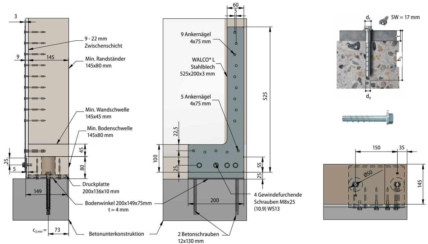
Stahlblech feuerverzinkt – 3mm für linke und rechte Anschlagposition
