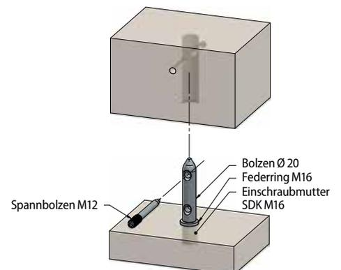
Technische Details WALCO® BOLT C130 mit Einschraubmutter
