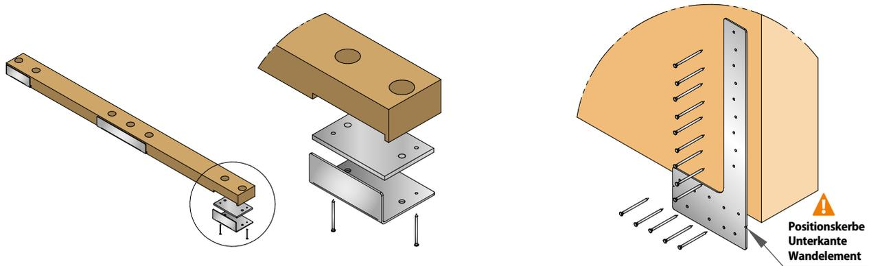
Bodenwinkel mit Druckplatte auf Bodenschwelle montieren.
