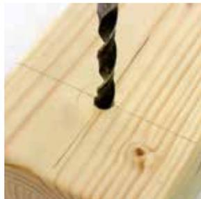
Vorbohren der Positionierschraubung.
