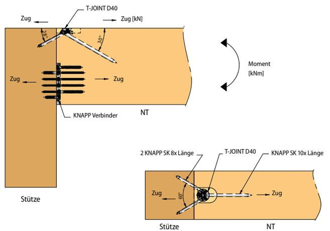
Zugverankerung von BSPH Boden-Wand
