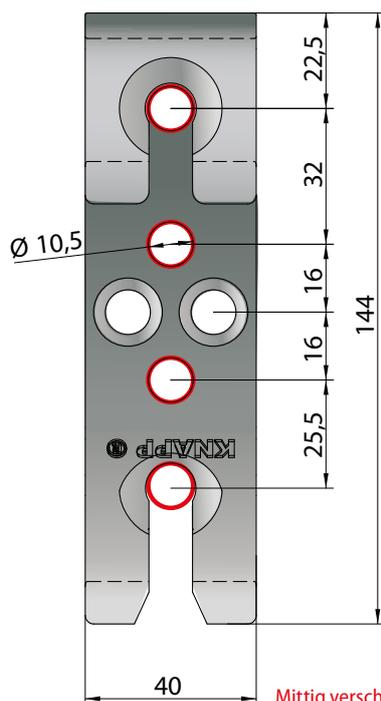
Mittig verschrauben bei Verwendung der Sperrklappe
