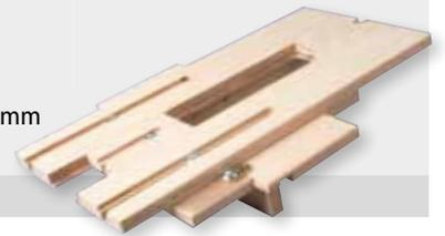
**Anwendung:** Zum Fräsen bei verdeckter Montage.
