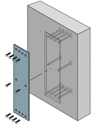
**I** Halfen HSC-B Stahlbauanschluss mit SK-Verschraubung planvertieft einbetoniert. [www.halfen.com](http://www.halfen.com)
