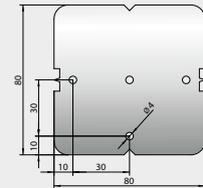
**Anwendung:** Zum Vorbohren der Verschraubung für die exakte Montage.
