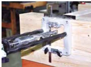
Bohren mit Stufenbohrer manuell oder industriell mittels Abbandanlage.
