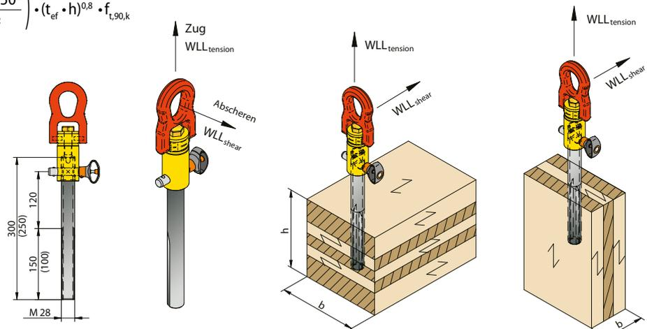
**WLL<sub>shear</sub> (WALCO® Lifting Tension Load) Beispielrechnung für WALCO® PIPE Hebevorrichtung**
