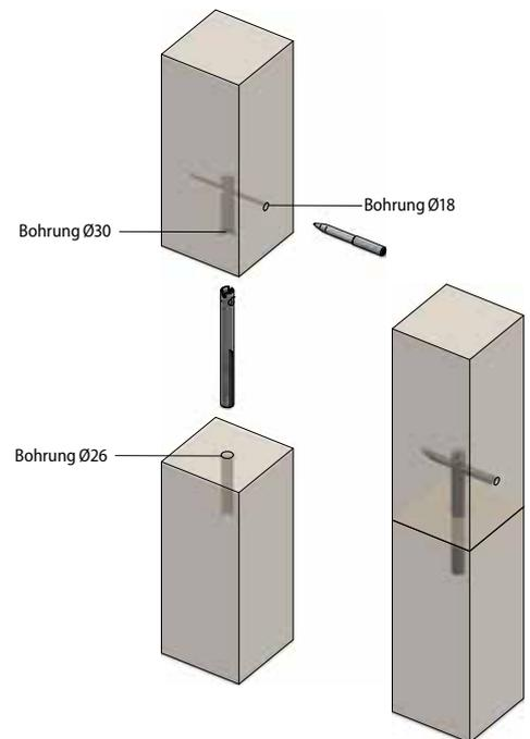
\* ... Mit der Eindrehtiefe kann die Festigkeit der Bauteilverspannung abgestimmt werden | Gewindesteigung 3 mm
