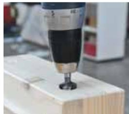
T-JOINT D20 Bohrung ca. 3 mm ansenken.
