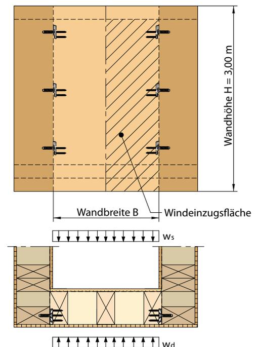
Die Grafik zeigt die Belastungsrichtungen und Installation. Die angegebenen Designwerte in der nachstehenden Tabelle sind für die Strukturanalyse nach EC5 (EN1995-1-1) zu verwenden.
