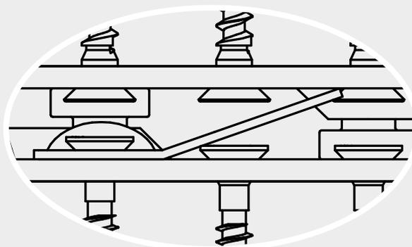
**Anwendung:** Sperrt entgegen der Einschubrichtung z.B. bei Windsogkräften.
