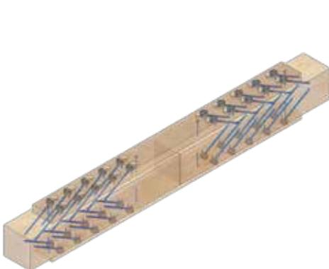
T-JOINT D35 W30 befestigte Laubholzlaschen von BSH-Zugstößen
