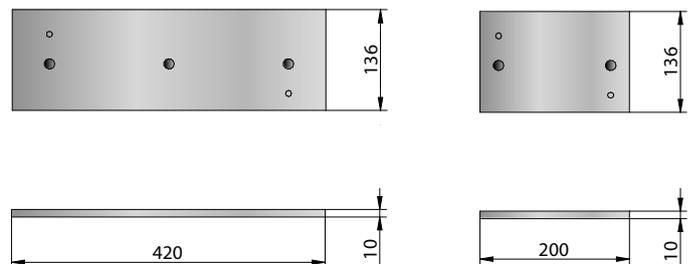
Bodenwinkel – 4 mm feuerverzinktes Stahlblech mit Befestigungsbohrungen.
