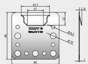
**Anwendung:** Sperrt und ist belastbar entgegen der Einschubrichtung z.B. bei Anschluss von Ankerzugkräften.
