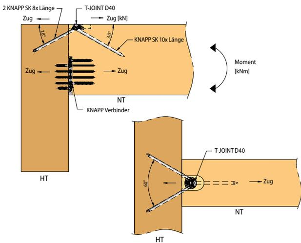
Zugstoß von NT - Stützen
