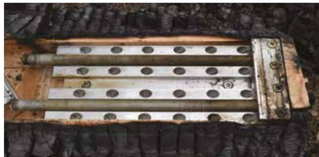
MEGANT® Verbinder nach 60 minütigem Brandversuch. Das Holz ist ringsherum verkoht. Der Verbinder hielt in dem Brandversuch der aufgetragenen Vertikallast stand.
