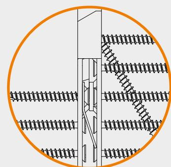
Anwendung: Sperrt entgegen der Einschubrichtung z.B. bei Windsogkräften.
