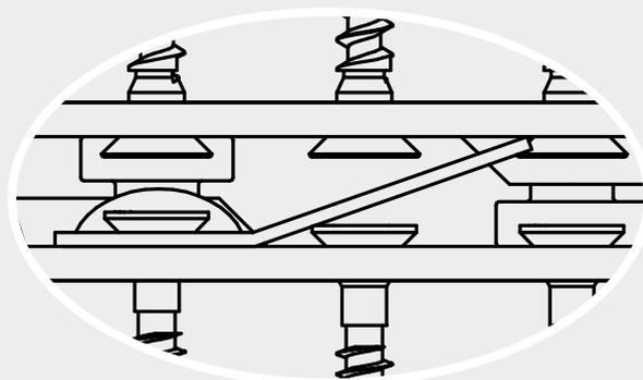
**Anwendung:** Sperrt entgegen der Einschubrichtung z.B. bei Windsogkräften.
