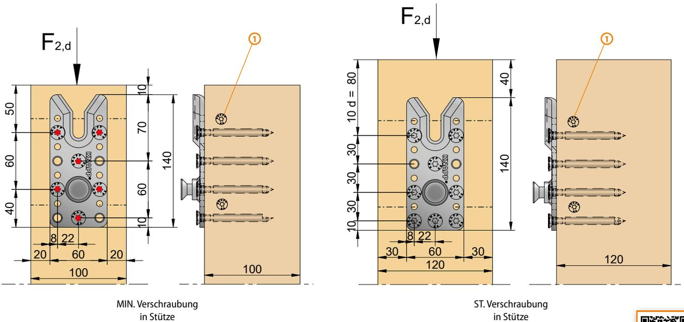
MIN. Verschraubung in Stütze
