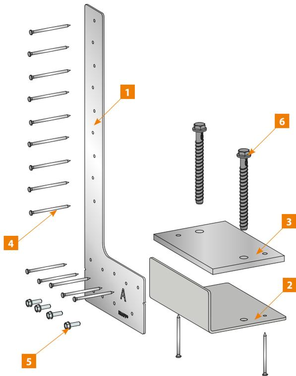
Für die M8x25 Schrauben **5** muss im Bodenwinkel **2** eine  $\varnothing 7,4$  mm Bohrung erstellt werden.
