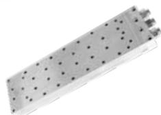
MEGANT® 550/150/50 ( $F_{2,Rk}$ 364,0 kN*)<br>1 Garnitur bestehend aus:<br>2 St. Verbinderplatten 490/150/25, 1 St. Spannbacke 150/50/50,<br>1 St. Spannbacke 150/50/50/M20, 3 St. Gewindestangen M20/580,<br>3 St. Muttern M20, 3 St. Beilagscheiben M20<br>Erforderliche Schraubenanzahl:<br>68 St. SK-Schrauben RICON® S 60 8x160 mm (Art. Nr. Z581)<br>12 St. SK-Schrauben RICON® S 60 8x240 mm (Art. Nr. Z530) | 1 | Garn. | 549,00 € |
