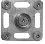
WALCO® 80 VK<br>mit verschraubtem Kragenbolzen ( $F_{2,Rk} = 7,88 \text{ kN}^*$ )<br>1 Set bestehend aus:<br>1 St. WALCO® 80,<br>4 St. WALCO® V80 Sechskantschrauben 10x60 mm mit Bohrspitze,<br>1 St. RICON® S D16 verschraubter Kragenbolzen,<br>1 St. RICON® S80 SK-Schraube 10x100 mm mit Bohrspitze<br>Passendes Gegenstück ist Art.-Nr. K101/Set = 1 Verbindung.   | 25    | Set   | <b>292,75 €</b><br>(11,71 € je Set)   |
