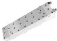
MEGANT® 430/150/50 ( $F_{2,Rk}$ 260,0 kN*)<br>1 Garnitur bestehend aus:<br>2 St. Verbinderplatten 370/150/25, 1 St. Spannbacke 150/50/50,<br>1 St. Spannbacke 150/50/50/M20, 2 St. Gewindestangen M20/460,<br>2 St. Muttern M20, 2 St. Beilagscheiben M20<br>Erforderliche Schraubenanzahl:<br>52 St. SK-Schrauben RICON® S 60 8x160 mm (Art. Nr. Z581)<br>12 St. SK-Schrauben RICON® S 60 8x240 mm (Art. Nr. Z530) | 1     | Garn. | 384,00 €   |
