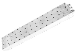
MEGANT® 730/150/50 ( $F_{2,Rk}$ 443,2 kN*)<br>1 Garnitur bestehend aus:<br>2 St. Verbinderplatten 670/150/25, 1 St. Spannbacke 150/50/50,<br>1 St. Spannbacke 150/50/50/M20, 3 St. Gewindestangen M20/760,<br>3 St. Muttern M20, 3 St. Beilagscheiben M20,<br>Erforderliche Schraubenanzahl:<br>92 St. SK-Schrauben RICON® S 60 8x160 mm (Art. Nr. Z581)<br>12 St. SK-Schrauben RICON® S 60 8x240 mm (Art. Nr. Z530) | 1 | Garn. | 895,00 € |
