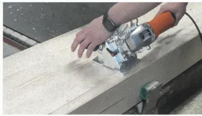
Die handliche und effiziente PlanHo Planfräse für den flexiblen Einsatz auf Holzbauelementen in Neu- und Sanierungsapplikationen (Bild links). Mit FRIDA Plan erzielt man perfekte Holzoberflächen.
