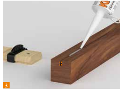
3 Nuten 4x12 mm fräsen und KNAPP®-Kleber PU+ in die Nut füllen oder auf den Klammersteg auftragen. Leisten auf den Klammersteg aufstecken.
