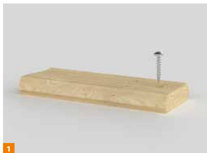
1 Blockleiste positionieren und verschrauben.
