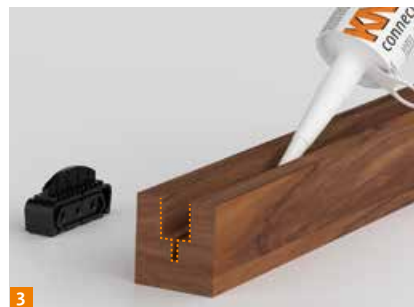
3 Stufennut fräsen und KNAPP®-Kleber PU+ in die Nut füllen oder auf den Klammersteg auftragen. Bauteil auf die Klammer aufstecken.
