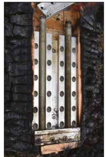
RICON®S Verbinder nach 90 minütigem und MEGANT® Verbinder nach 60 minütigem Brandversuch. Das Holz ist rings herum verkohlt. Die Verbinder hielten in dem Brandversuch der aufgetragenen Vertikallast stand.
