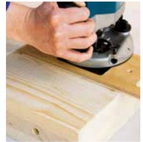
Abbundmaschine oder Ausfräsen mit Oberfräse
