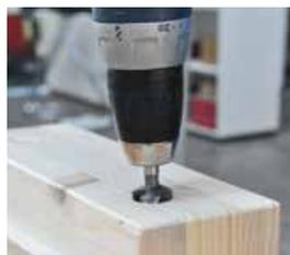
T-JOINT D20 Bohrung ca. 3 mm ansenken.
