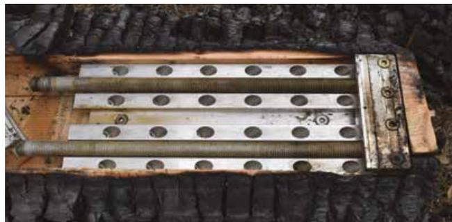
MEGANT® Verbinder nach 60 minütigem Brandversuch. Das Holz ist rings herum verkohlt. Der Verbinder hielt in dem Brandversuch die aufgebrachte Vertikallast stand.
