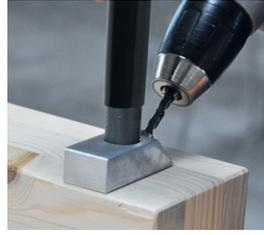
Mit T-JOINT-Bohrschablone vorbohren.
