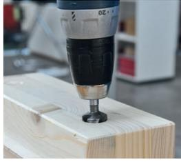
T-JOINT 20 Bohrung mit ca. 3 mm Fase ansenken.
