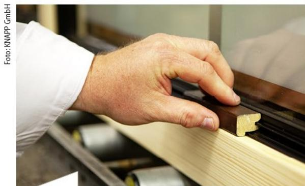
Mit der Anpressschablone wird die FIXclip-Schiene eingesetzt
