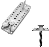
RICON® S 200/60 VK ( $F_{2,Rk}$ 34,9 kN*)<br>Bestehend aus:<br>2 St. RICON® S 200/60 D12<br>2 St. RICON® S verschraubter Kragenbolzen,<br>9 St. RICON® S SK-Schrauben 8x80 mm,<br>9 St. RICON® S SK-Schrauben 8x160 mm<br><b>Alternativ längere Schrauben im Hirnholz möglich:</b><br>RICON® SK-Schrauben 8x240 mm ( $F_{2,Rk}$ = 41,4 kN*)       | 1     | Garn. | 31,30 €    |
