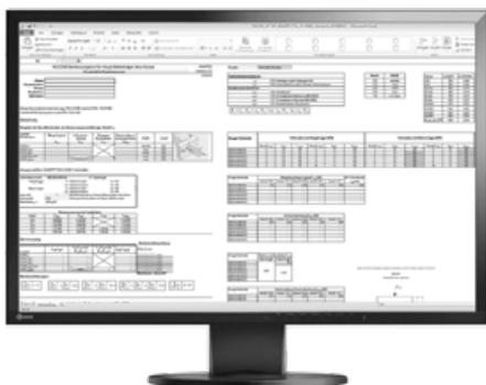
Knapp stellt ein Bemessungstool zur Verfügung. Eine schnelle Vordimensionierung der ausgewählten Verbinder wird so ermöglicht. Das „Werkzeug“ ist für die Berechnung der Haupt-/Nebenträger Verbinder RICON®, RICON® Edelstahl und RICON® S verfügbar. Es stellt eine Arbeitshilfe dar und bietet dem Planer und Statiker eine Berechnungsgrundlage für die statische Berechnung der Projekte.
