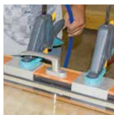
Scheibe gegen Außenabdichtung anpressen
