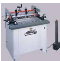
Bohren mit Dübel-lochbohrmaschine
