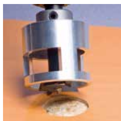
Einfaches Bohren mit Tiefenanschlag
