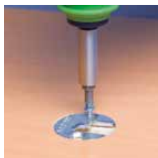
Verschrauben mit SK-Schrauben
