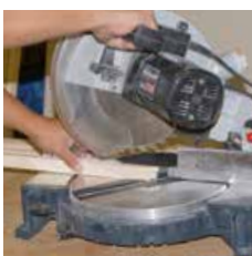
Glasleiste und FIXclip-Schiene zuschneiden
