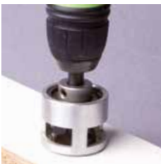
Einfaches Bohren mit Tiefenanschlag
