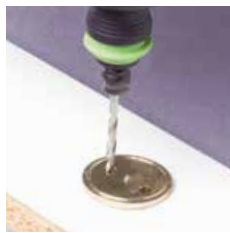
Mit Körner Bohrpositionen übertragen und Ø = 5 mm Löcher 12 mm tief vorbohren
