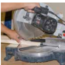
Glasleiste und FIXclip-Schiene zuschneiden
