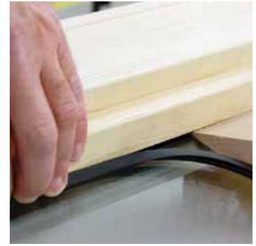
Anpressdruck über die Keildichtung
