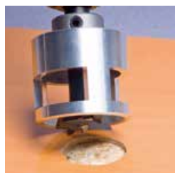
1) Einfaches Bohren mit Tiefenanschlag
