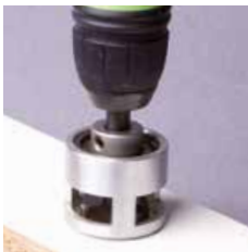
1) Einfaches Bohren mit Tiefenanschlag
